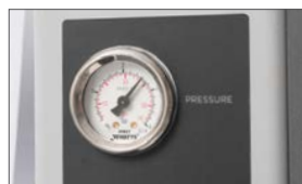
Manometro per visualizzare la pressione del rullo superiore
