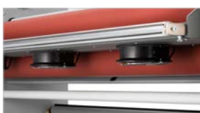
Piano aspirante anteriore per la stesura di materiali sottili (optional)
