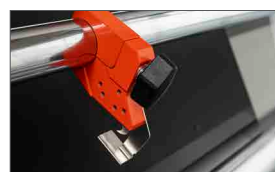
Unità di taglio per rifilare il film qualora fosse più largo della lastra
