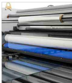
Sistema di pulizia a contatto del materiale da laminare con barra antistatica per rimuovere la polvere dalla superficie
