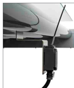
Sensore per bloccare l'avanzamento della lastra in uscita sulla rulliera
