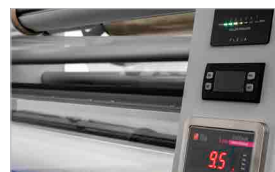
Regolatore tensione del film con cella di carico: permette di avere sempre la stessa tensione indipendentemente dal diametro della bobina (optional)
