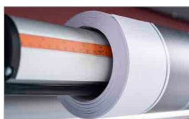
Scala millimetrata su ogni albero per il corretto allineamento dei materiali
