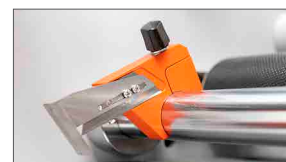
Unità di taglio con due coltelli per rifilare le bobine
