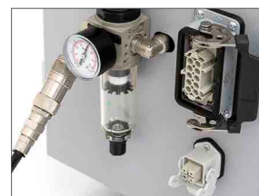
Connettori per il collegamento esterno di una possibile taglierina e di un riavvolgitore
