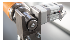
Contropunta con movimento automatico e pneumatico per facilitare carico e scarico del materiale
