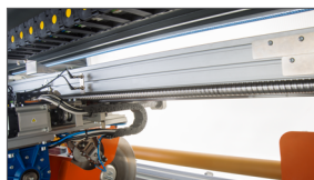
Movimentazione degli assi XY tramite motore brushless
