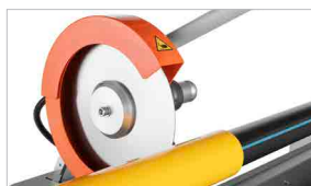
Lama a doppio bisello (standard). Lama a singolo bisello (optional) per rotoli di piccole dimensioni
