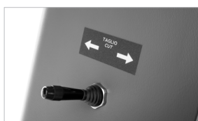
Taglio pneumatico del materiale dopo il riavvolgimento
