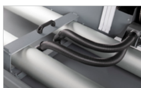
Sistema integrato aspirazione trucioli per pulizia della macchina
