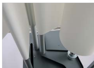
Ballerino verticale passaggio supporto di stampa dello svolgitori e riavvolgitori
