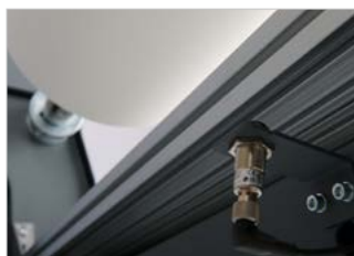
Sensore di lettura diametrale della bobina dello svolgitori e riavvolgitori
